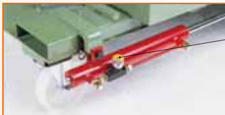
CILINDRO CON VALVOLA REGOLABILE LIMITATRICE DI FLUSSO CYLINDER EQUIPPED WITH AN ADJUSTABLE FLOW LIMITING VALVE
